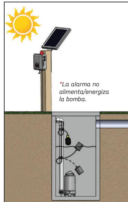
Debe instalarse en un lugar con luz solar adecuada para la carga solar. La unidad en alarma constante sin carga solar funcionará durante aproximadamente 24 horas.
